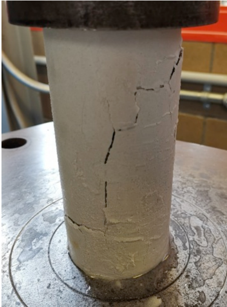
Figura 1. Localización de la deformación ante carga mecánica en una arcilla cementada artificialmente (Romero, 2020)
