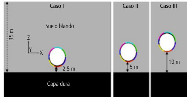
Figura 2. Distancia entre la capa dura y la cubeta del túnel; a) caso I, a 2.5 m; b) caso II, a 5.0 m; c) caso III, a 10.0 m.
