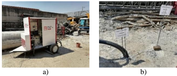
Figura 2. Equipo móvil TRT-IIUNAM, b) Pozo intercambiador de calor de prueba (izquierda) y pozo de observación instrumentado (derecha) (Rivera-Martínez, 2021).
